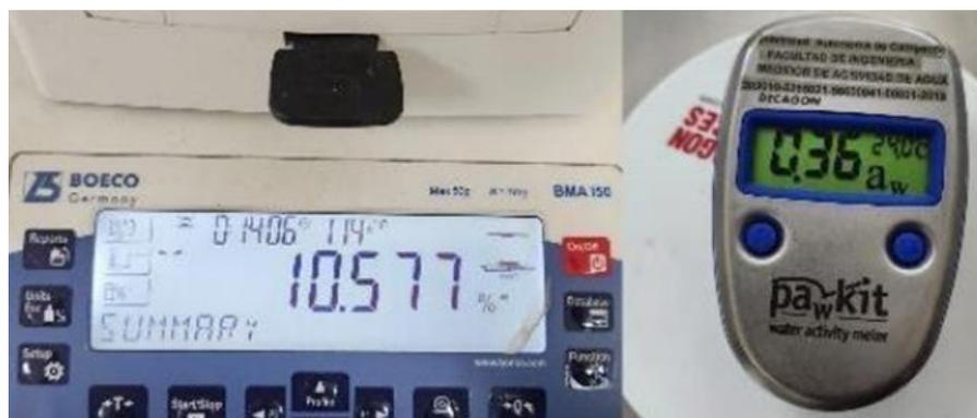
Figura 9. Medición de parámetros al finalizar el proceso de secado
