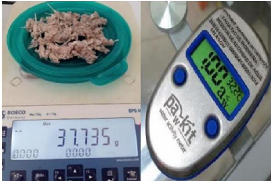
Figura 7. Medición de parámetros iniciales del residuo de pescado
